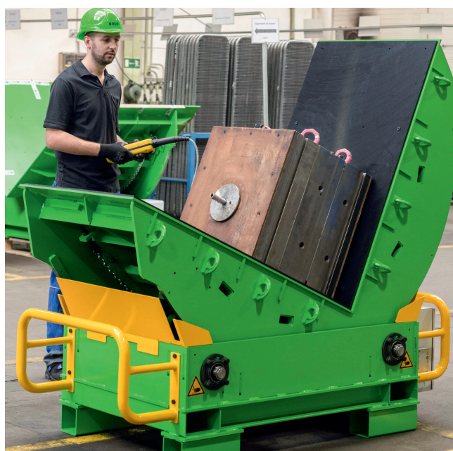
Drehen und wenden, wie man will: Axiale Drehbewegungen für Werkzeuge bis 64 Tonnen Gewicht sind möglich. © Roland Hasenmüller/Rud
